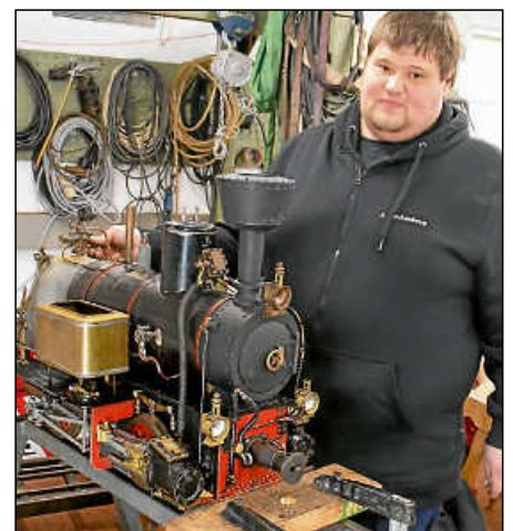
Jan Hackenberg richtet in der Werkstatt eine etwa 40 Jahre alte österreichische Stainz-Dampftraktorlok mit Kesselschaden wieder her.
