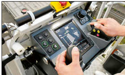
Neu im Korb der Drehleiter ist unter anderem ein Display mit verschiedenen Funktionen.
