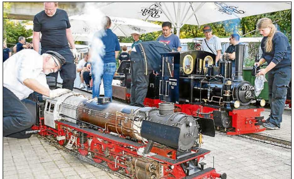
Hartmut Steinke (l.) hat mit seinem Bruder Martin etwa 13 bis 14 Jahre an seiner originalgetreu nachgebauten, ölgefeuerten Lok gebaut. Zum Dampfspektakel fuhr sie das erste Mal.
